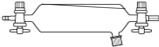
Abbildung 2: gedrehte Gasmaus mit injizierter Gasblase
